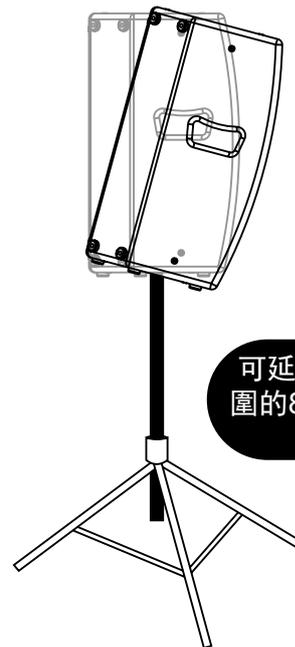
可延伸聲音投射範圍的8度傾斜支架安裝孔
