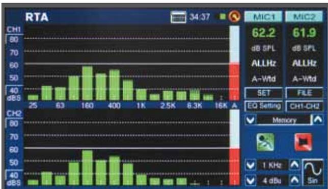
即時分析(RTA)包括可調的輸入方式, 峰值保持時間, 加權, 響應時間, 以及可精確至1/6oct的解析度(此處為2/3oct)。
