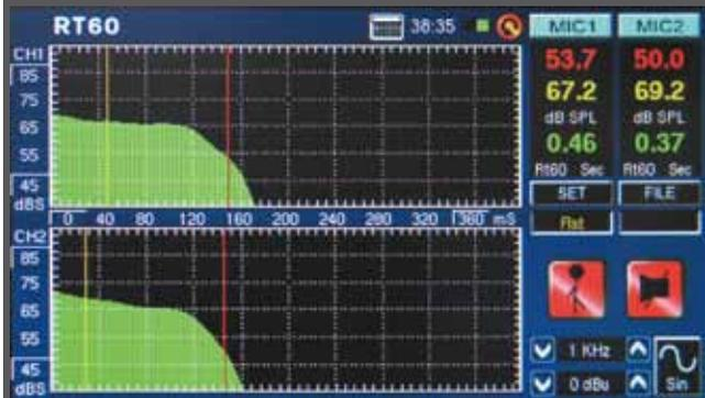
混響時間(RT60)擁有13種可選頻率濾波器可對混響衰減時間作出詳細的分析。
