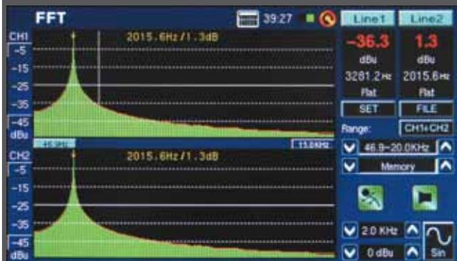
快速傅立葉轉換(FFT)可提供詳細的即時分析資料, 當中包括傳統即時分析無法測試到的諧波失真。
