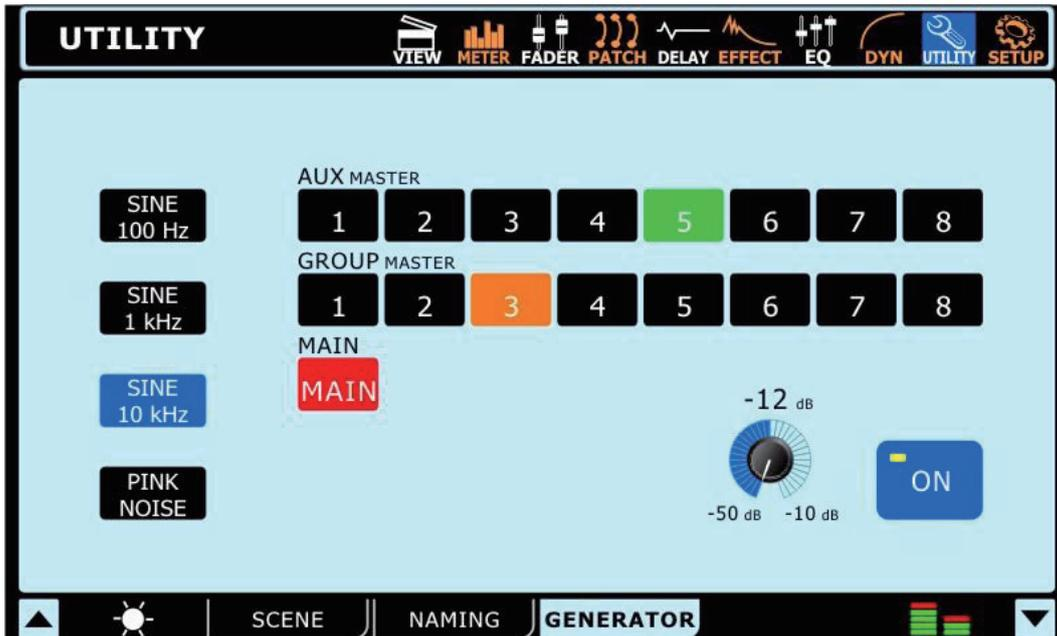
Por el generador de Señal, los usuarios pueden enviar una onda Seno (100Hz, 1kHz o 10kHz) o una señal de ruido rosa a cualquiera de las mezclas AUX o Grupo, así como la mezcla principal, si es necesario. El botón On/Off permite a los usuarios encender y apagar el generador de señal, y el control de nivel que lo acompaña (control giratorio virtual) permitirá el ajuste de nivel de la señal.
