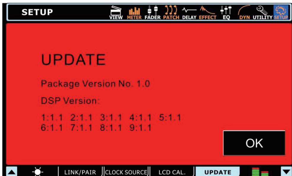
La función de actualización permite a los usuarios actualizar el firmware del Summit de la última versión. Esto se realiza insertando una tarjeta SD que contiene la última actualización del firmware en la ranura de la tarjeta SD en la parte trasera del mixer, y a continuación seleccionando la ficha de actualización. Asegúrese de revisar la versión actual antes de actualizar a evitar la actualización de una versión caducada de firmware.
