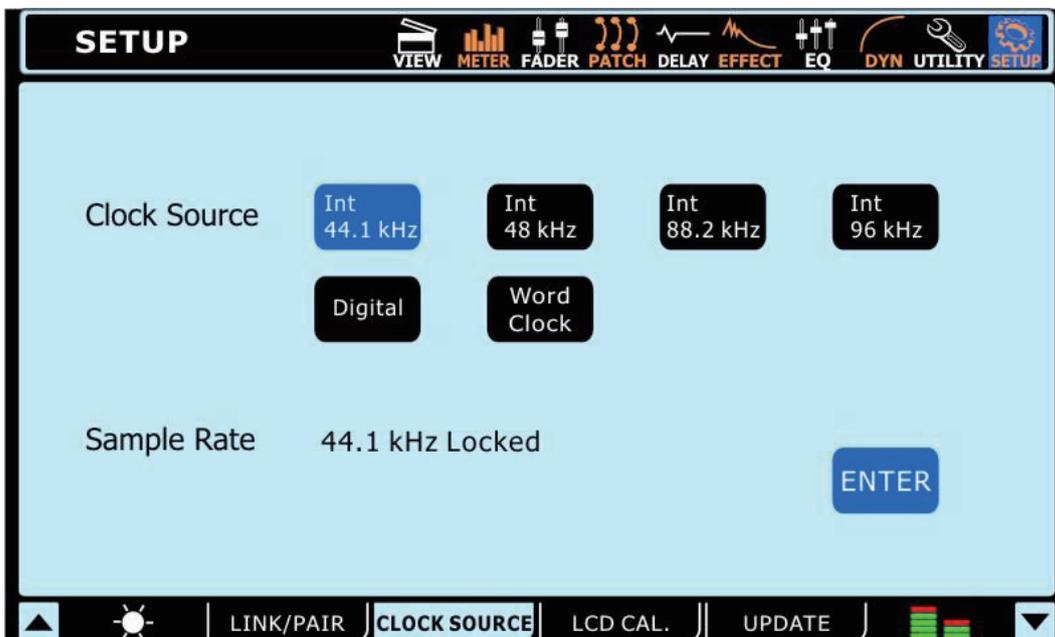
En el tab de Clock Source de menú de Utilidad, los usuarios pueden seleccionar la fuente de clock de entrada y salida de AES/EBU. La fuente de clock puede ser seleccionada desde Interno (con índice de muestreo de 44.1 kHz, 48 kHz, 88.2 kHz y 96 kHz), el dispositivo digital o entrada/salida de Word Clock.
