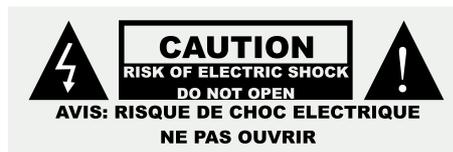
Ce symbole apposé sur l'appareil attire l'attention de l'utilisateur sur la présence de tensions non isolées à l'intérieur du boîtier de l'appareil susceptibles de constituer un risque d'électrocution.
