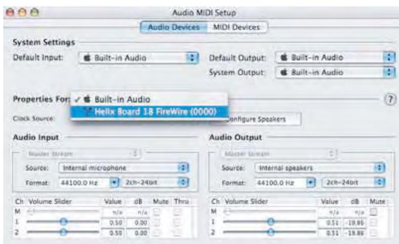
En bas de la fenêtre, vous pouvez éditer la configuration de l'Helix Board 18 FireWire et changer des réglages comme la fréquence d'échantillonnage et l'horloge de référence. Vous pouvez aussi faire de l'Helix Board 18 FireWire votre périphérique d'entrée et/ou de sortie par défaut.
