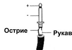
Рисунок 4. Подключение акустической системы
