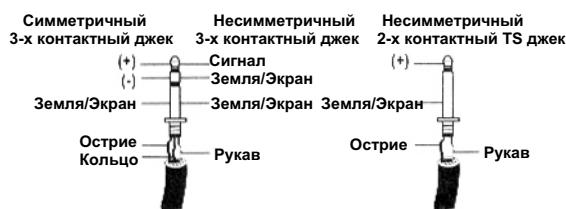
Рисунок 1. TRS Симметричный и Несимметричный
