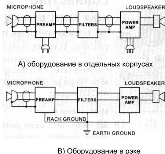
Рисунок 5 Примеры подключений экранов к корпусам
