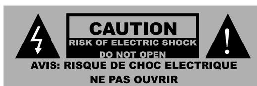
Данный знак предупреждает о наличии внутри корпуса неизолированного участка опасного напряжения, достаточного для поражения электрическим током.
