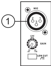
**NB.** Cuando estas entradas están usadas con micrófonos de condensador, dicha Potencia Fantasma debe ser activada. Sin embargo, cuando esta potencia está conectada a un terminal solo (desbalanceado) de micrófonos o instrumentos no se debe de usar entradas de Mic.
