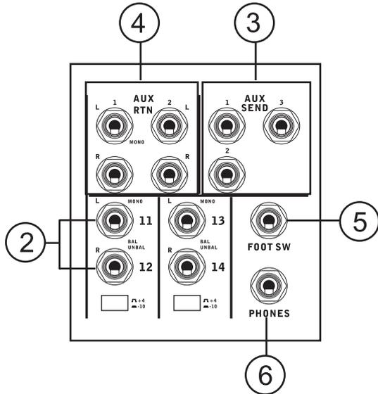
注意：将任意设备插入调音台相应的EFX Return输入(例如，AUX Return 2)，调音台的内置数字效果处理器将不再作用。
