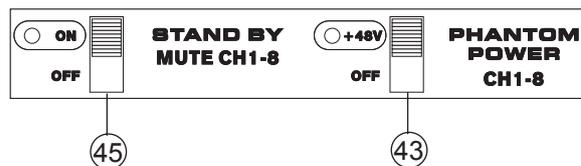
Dieser Schalter ist ein globaler MUTE Schalter für alle Monokanalzüge, d.h. die Kanäle 1 ~ 8. Ist der Schalter in der oberen Position (ON), werden diese Eingangskanäle stumm geschaltet, d.h. deren Ausgänge gelangen in keine Sammelschiene. Zur Kontrolle blinkt die LED auf. Lediglich die TAPE IN Eingänge (#4) und die STEREO RETURNS 1 & 2 (#7) sind noch aktiv.
