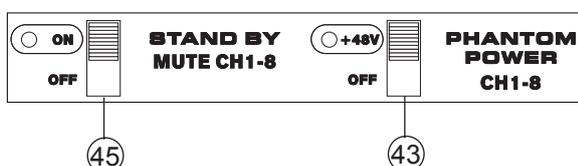
Die elektrischen Schaltungen in Kondensatormikrofonen und aktiven DI Boxen benötigen eine Spannungsversorgung. Diese wird entweder durch eine interne Batterie oder über die Phantomspeisung hergestellt, die vom Mischpult über die Leitungen des Mikrofonkabels transportiert wird.
