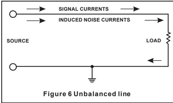
Diese Art der Verkabelung findet sich in der Regel bei den meisten Geräten der Unterhaltungselektronik und Videosystemen. Es gibt einen Leiter der das Signal trägt, der andere ist für die Erdung/Masse bestimmt. Im Normalfall, bei Signalen mit geringerem Pegel, schirmt der Masseleiter das signalführende Kabel ab.
