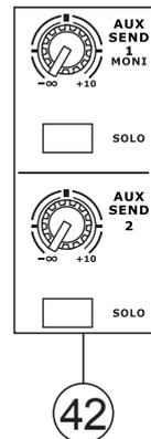
Ganz nach links gedreht, sind die Signale der Ausspielwege ausgeblendet, in der 12-Uhr Position des Reglers befindet sich die „Unity Gain“ Stellung, rechts davon kann das Signal bis max. +10 dB angehoben werden.
