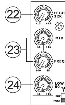
Die Monokanäle von HELIX BOARD 18 FIREWIRE MKII sind mit einer Dreiband Klangregelung mit parametrischen Mitten ausgestattet. Die Stereokanäle 7/8 und 9/10 haben ebenfalls eine Dreiband Klangregelung mit einer festen Mitte. Die beiden Stereokanäle 11/12 und 13/14 haben eine Vierband Klangregelung mit zwei fest eingestellten Mittenfrequenzen.
