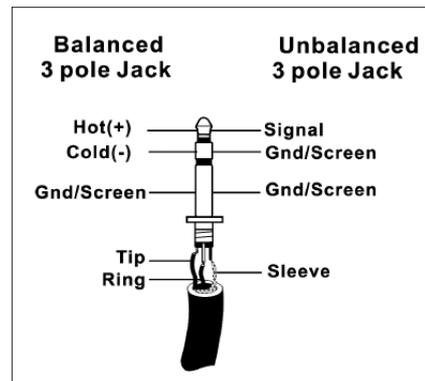
Schauen wir uns noch mal das unsymmetrische System an. Dort fließt der Strom des Signals vom Signalleiter zum Masseleiter, also von plus nach minus. Das Massepotential der beiden verbundenen Geräte ist aber nicht identisch. Das bedeutet dass dieses System viel eher von äußeren Störeinstreuungen beeinflusst wird.
