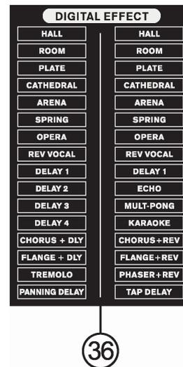
Diese Anzeige listet die verschiedenen eingebauten Effekte auf, die Sie dem Audiosignal hinzufügen können. Die linke Liste bezieht sich auf Effektprozessor 1, die rechte auf Prozessor 2. Wenn Sie die Effektnummer mit dem Programmwahlknopf PROGRAM (#37) anwählen, leuchtet der entsprechende Name des Programms auf, und der entsprechende Effekt wird sofort aufgerufen. Eine genauere Auflistung aller verfügbaren Effekte samt Parameter finden Sie in der Tabelle „DIGITALE EFFEKTPROGRAMME“.
