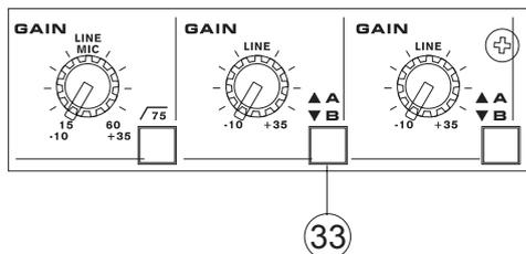
Dieser Schalter in den Stereokanälen 9/10 und 11/12 bestimmt, welche Eingangsquelle für den jeweiligen Stereoeingangskanal aktiv ist. Ist er nicht gedrückt, gelangt das Signal der Eingänge „A“ in den Kanal, also der 6,3 mm Line Klinkenbuchsen (#4). Wenn er gedrückt wird, gelangen die Signale an den Cinch Buchsen, also der Eingänge „B“, in den jeweiligen Stereokanal.
