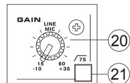
für das Signal im Kanalzug, wodurch der Pegel des externen Geräts dem Mixer-internen Verarbeitungspegel angepasst wird. Wird die Eingangsverstärkung zu hoch eingestellt, verzerrt das Signal und der Kanal wird übersteuert. Ist sie zu niedrig, treten die Nebengeräusche über Gebühr hervor und u.U. ist die Signalstärke für die Ausgangssekktion des Mixers sowie die verschiedenen Auspielwege nicht ausreichend.
