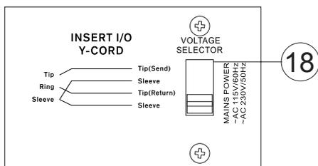
Dieser Schalter passt Ihren Powerpod Deluxe Mischverstärker der örtlich vorgegebenen Netzspannung an. Bevor Sie den Netzstecker einstecken, vergewissern Sie sich, dass die Betriebsspannung mit der örtlichen Netzspannung übereinstimmt.
