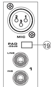
Dynamikumfang erheblich erweitert, und die Gefahr des Clippings im Eingang gebannt. Beispiele für solche Signale sind: Bass Drum, Snare, E-Bass, Kondensatormikrofone für Gesang, etc.
