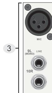
Durch diese Möglichkeit der Doppelbelegung erhöht sich die Vielseitigkeit der Powermixer enorm. Jedoch sollten Mikrofon- und Line Eingänge nicht gleichzeitig belegt werden, denn sonst kommt es zu Beeinträchtigungen der Signale und womöglich zu Rückkopplungen – also entweder nur das Mikrofon anschließen oder ein Line Pegel Gerät.
