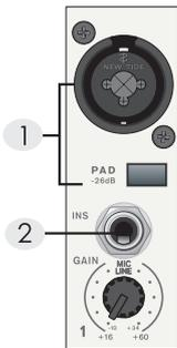
Wenn Sie ein Kondensatormikrofon oder eine aktive DI Box benutzen, benötigen Sie +48V Phantomspeisung. Wenn Sie die Phantomspeisung einschalten (#50), sollten alle Lautstärke Regler (Eingangskanäle, AUX, Zone 2 und MAIN) runter gedreht sein. Um übermäßige Störgeräusche in den angeschlossenen Lautsprechern zu vermeiden, sollten Sie Kondensatormikrofone nicht einstecken, solange die Phantomspeisung eingeschaltet ist.
