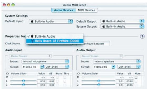
In diesem Fenster kann der Anwender die Eigenschaften und Einstellungen für das Helix Board 12 FireWire den eigenen Bedürfnissen anpassen. Es können beispielsweise die Sampling Frequenz oder Clock Source geändert werden. Sie können auch bestimmen, dass Helix Board 12 FireWire das Standard Gerät im Eingang und Ausgang wird.
