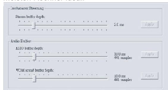
Die *ASIO Buffer Depth* kann in einem Bereich von 4 bis 40 ms eingestellt werden. Hiermit wird die Latenzzeit für die Audiodaten eingestellt, die von Software empfangen wird, die auf ASIO Treibern basiert (einschließlich Cubase LE).
