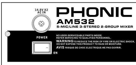
An die dreipolige Buchse wird das mitgelieferte, externe Netzteil angeschlossen. Achten Sie darauf, den Stecker richtig einzustecken – eine kleine „Nase“ im Stecker passt in die entsprechende Einbuchtung.
