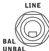
An diese dreipolige 6,3 mm TRS Klinkenbuchse werden Geräte mit niederohmigem Linienpegel angeschlossen, also mit
