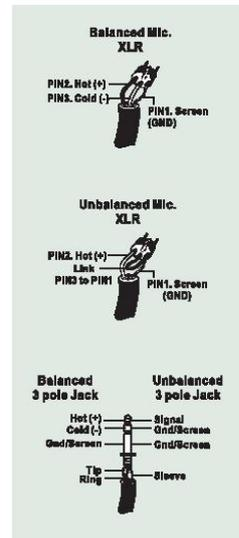
Schauen wir uns noch mal das unsymmetrische System an. Dort fließt der Strom des Signals vom Signalleiter zum Masseleiter, also von plus nach minus. Das Massepotential der beiden verbundenen Geräte ist aber nicht identisch. Das bedeutet dass dieses System viel eher von äußeren Störeinstreuungen beeinflusst wird.
