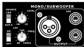
Schalter (#23) steht. In der Stellung „L&R“ ist das Summensignal unabhängig von der Stellung des MAIN Faders (#60), in der Stellung „AUX 4“ hängt es vom Pegel des Ausspielweges AUX SEND 4 ab, der mit dem eigenen Regler (#48) eingestellt wird. Das MONO Signal verfügt nochmals über einen eigenen Lautstärkereglern (#23).
