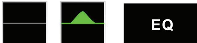
**GEQ:** 此功能仅供 MAIN 混音使用。此功能为 31 段图像式参量均衡，可于 MAIN 推轨上方检视。按下图标可以开启 GEQ 菜单。
