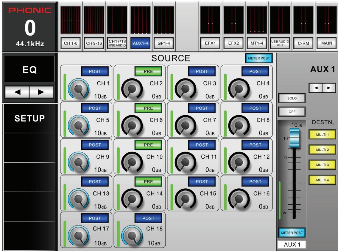
**Virtual Rotary Controls (虚拟旋钮控件):** 这些控件可在 AUX 菜单中找到。每个旋钮控件可透过简单的点选控件来进行调整，并上下滑动来调整电平。电平会以分贝为单位列示在画面上。控件本身中会有虚拟的电平标示。
