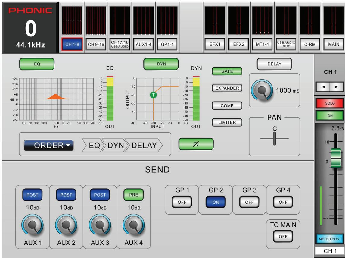
**EQ On/Off and Display (EQ 开/关和显示):** 此按钮可开启频道 EQ。若未启用此按钮，EQ 会被旁路。随附的显示画面会显示频道目前所选的 EQ 曲线 (如用户在 Equalizer (参量均衡) 功能中所选的功能)。选取显示窗口会直接跳至 Equalizer 功能，用户可以在那里调整 EQ 属性。EQ 的输出电平量表位于 EQ 曲线图旁。
