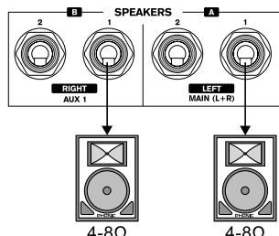
**Dos Altavoces por Canal:** Cuando se conecta dos altavoces a esta salida, la carga de cada altavoz deberá ser de entre 8 y 16 ohms (dos altavoces de 8 ohms formaran una carga total de 4 ohms, dos altavoces de 16 ohms daran una carga total de 8 ohms, etc.)
