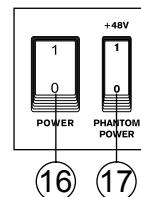
**NOTA.** La fuente fantasma deberá utilizarse en conjunto con micrófonos balanceados. Cuando la fuente fantasma es activada, los micrófonos que tienen una sola terminación (desbalanceados) e instrumentos, no deberán ser utilizados en las entradas de Micrófonos. La fuente fantasma no causará daño a la mayoría de los micrófonos dinámicos, de cualquier manera si no estás seguro, deberás consultar el manual de usuario del micrófono.
