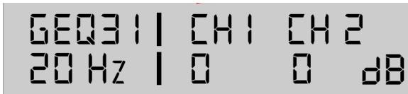
El iAMP DSP dispone de un ecualizador gráfico de 31 bandas en cada uno de los dos canales de salida. Hay, por supuesto, 31 frecuencias diferentes entre 20 Hz y 20 kHz que se pueden ajustar para una tasa de  $\pm 15$  dB.
