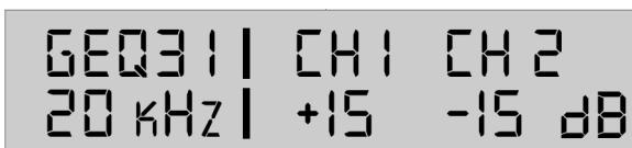
Los ajustes de GEQ se pueden restablecer mediante la opción "Reset". Si lo hace, devolverá de nuevo el boost/cut a 0 dB en cada frecuencia del GEQ de 31 bandas.
