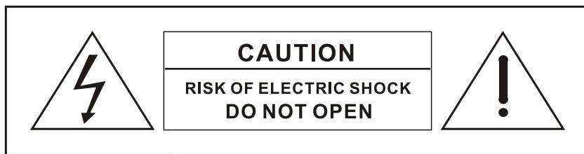
Данный знак предупреждает о наличии внутри корпуса неизолированного участка опасного напряжения, достаточного для поражения электрическим током.
